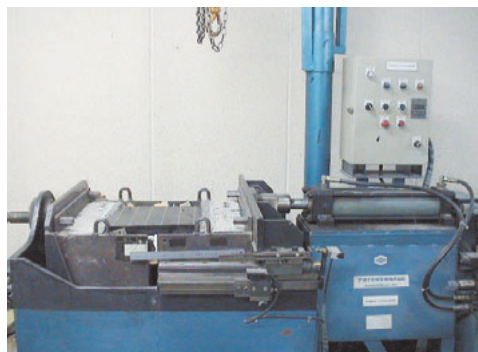
▲伸縮耐久性試験状況
